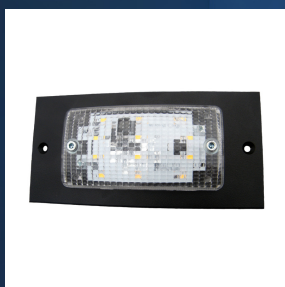
LAMPA OŚWIETLENIA STOPNI SYMBOL : LOS4 NAPIĘCIE : 15-30V PRĄD : 130MA STRUMIEŃ ŚW. : 220 WYMIAR:206X100 MM
