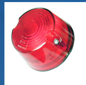
LAMPA POZYCYJNA CZERWONA SYMBOL: LPC NAPIĘCIE : 15-30V PRĄD : 80MA ZAMIENNIK LAMPY POLMO KWIDZYŃ
