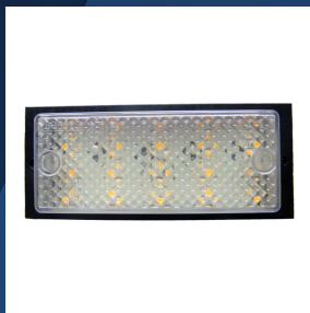
LAMPA OŚWIETLENIA STOPNI SYMBOL : LOS2 NAPIĘCIE : 15-30V PRĄD : 240 MA STRUMIEŃ ŚW : 560 LM WYMIAR: 124X50 MM
